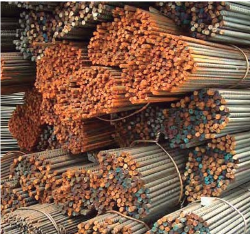
BARRA DE HIERRO 6 ó 12 m. Diámetros de 6, 8, 10, 12, 16 y 20mm.
