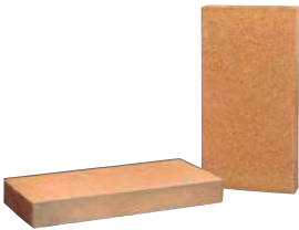
LADRILLO REFRACTARIO 2 modelos: ladrillo refractario o picholin medias rasillas refractarias. Piezas de diferentes medidas. Calidad R-40/9-H. Densidad de alúmina 31%. Temperatura de clasificación de 1.300°.
