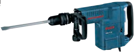
MARTILLO PICADOR MAX GSH 11 E PROFESSIONAL Extraordinaria potencia con 16,8 J de energía de impacto. Nivel reducido de vibraciones. Permite cincelar sin aplicar excesiva presión. 1.500 W. 16,8 J. 900-1800 i.p.m. SDS-max. Electrónico. Incluye: Maletín.
