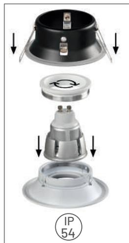
\*Esquema de montaje para IP 54
