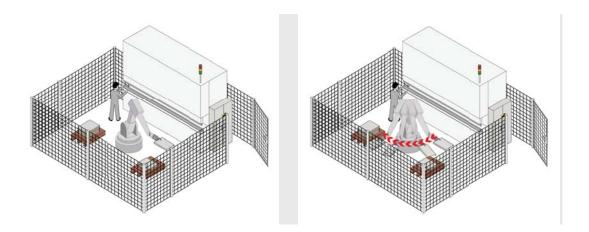
En la imagen de la izquierda, el dispositivo de enclavamiento de la puerta produce la parada del robot y/o de las demás máquinas al abrirse la puerta; en la imagen de la derecha, la función de seguridad se adapta a las zonas de detección. Por ejemplo, la velocidad a que se mueve el robot depende de la detección de presencia de personas en su proximidad. Como
