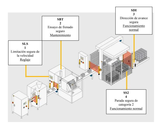
En resumen, el responsable del diseño de la línea debe decidir qué funciones de seguridad son necesarias para proteger de los diferentes riesgos y seleccionar en el mercado los componentes de seguridad necesarios, incluyendo si procede los controladores de movimiento seguro (servos y variadores de velocidad de seguridad) capaces de realizar dichas funciones y con la fiabilidad (véase el punto siguiente) adecuada.
