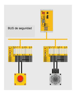
Actualmente existe ya una amplia gama de dispositivos que se pueden conectar mediante cable bus o mediante una red Ethernet. Los datos relacionados con la seguridad pueden viajar separados de los datos "normales" de las funciones propias de la máquina mediante cables de bus separados como se muestra en la imagen que sigue, o pueden viajar por el mismo cable de bus.
