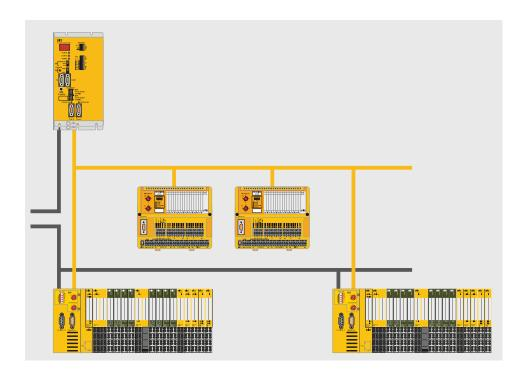
Estos medios de comunicación están certificados como SIL **3** de acuerdo con las normas EN IEC 61508 y EN IEC 62061 y como PL **e** de acuerdo con la Norma EN ISO 13849, y pueden utilizar hilo de cobre, conexión inalámbrica, por luz o por fibra óptica.
