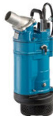
Sistema de control automático por electrodos. La gama KTZE está equipada con un novedoso sistema de control de nivel electrónico. La bomba funciona mientras el líquido contacta con el electrodo. Si el líquido desciende por debajo del sensor, se acciona un temporizador interno manteniendo la bomba en funcionamiento durante 1 minuto aproximadamente, desactivando la bomba si al cabo de este tiempo el líquido no vuelve a contactar.
