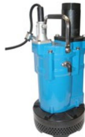
Sistema de control automático por electrodos. La gama KTZE está equipada con un novedoso sistema de control de nivel electrónico. La bomba funciona mientras el líquido contacta con el electrodo. Si el líquido desciende por debajo del sensor, se acciona un temporizador interno manteniendo la bomba en funcionamiento durante 1 minuto aproximadamente, desactivando la bomba si al cabo de este tiempo el líquido no vuelve a contactar.
