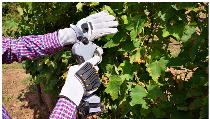
El tejido conductor potencia la transmisión eléctrica y permite el óptimo funcionamiento del sistema de seguridad de las tijeras.
