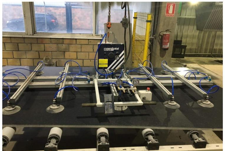
Los diferentes sistemas de basculación, basic, ergo, neumático, eléctrico, permiten voltear la pieza hasta 180°, lo que facilita al operario el posicionado de los materiales para su trabajo.
