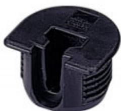
Caja de herraje de unión fabricado en plástico que se embute en el mecanizado del estante con lengüeta de seguridad que evita el movimiento y permite el montaje y desmontaje del estante.
