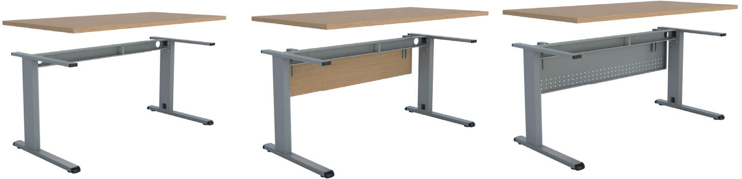
Estructura de la mesa sin tapa: AUTOPORTANTE. Sujeción directa del travesaño de electrificación a los laterales metálicos que dotan a la estructura de extrema rigidez. El faldón, tanto metálico como de tablero es decorativo y no estructural. Travesaño fabricado en chapa de acero laminado de 1.2 mm, movimiento telescópico con acceso desde el interior y salida al interior de la viga de cada pata y al lado posterior de la mesa para facilitar el cableado y la salida a la superficie.
