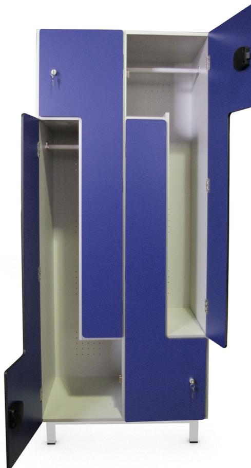
**BISAGRAS:** Fabricada en acero inoxidable 304 tipo con anclaje al costado. Tornillería AISI 304. Anclaje a costados con tuercas embutidas de plástico. Anclaje a puerta con taladros de 3 mm en centro de mecanizado.
