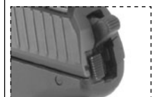
Palanca de desarmatillado bajo el martillo
