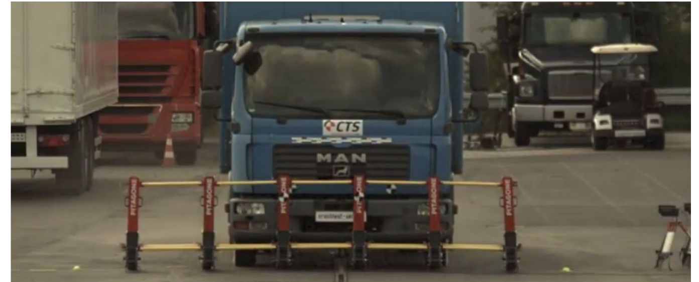
Vehículo testado de masa 7410 kg antes del impacto
