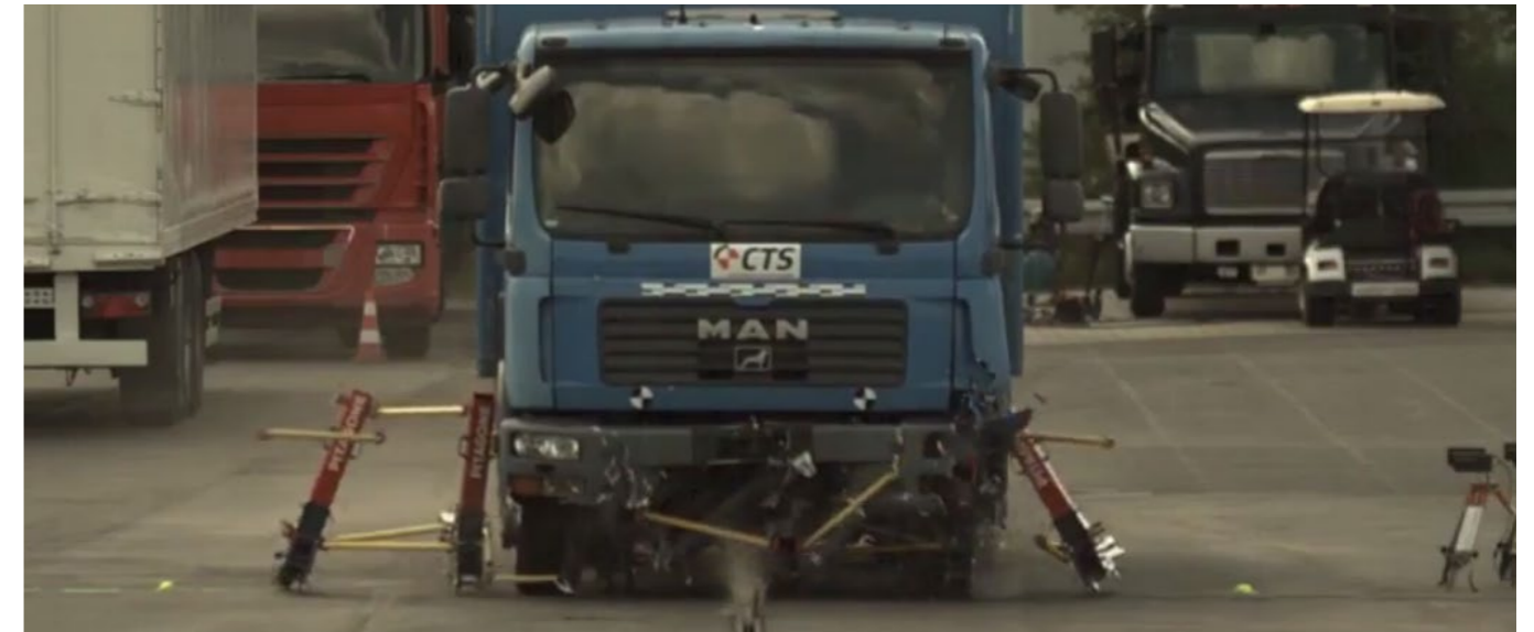
Impacto del vehículo a 48,3 km/h
