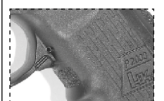
Detalle del retén ambidiestro del cargador
