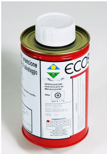
Humógeno para señalización con humo de color naranja. Tipo aprobado por D. M. N ° 193/82 del Min. M. M. recipiente cilindrico de metal. Dimensiones: mm. 150 mm x h. 90. Tapón de rosca con junta de estanqueidad. Duración humo: 180 seg. Validez 4 años a partir de la fecha de fabricación. Peso: Kg. 0,550. Solas 74/96 - Certificado CE
