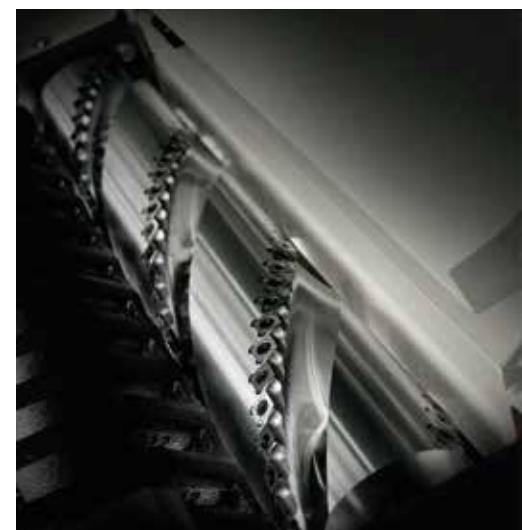
eje cepillo "Xylent" con cuchillas dispuestos en espiral Las 3 espirales de cuchillas garantizan un excelente acabado. Permite trabajar a la máquina en modo extremadamente silencioso. Mejora la aspiración mediante la producción de virutas de dimensiones reducidas. Aumenta la duración de las cuchillas, con la posibilidad de aprovechar los cuatro lados cortantes.
