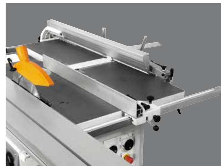
mesa suplementaria sobre el carro deslizable Para el soporte de tableros de gran tamaño.
