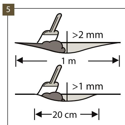
Asegurarse de que el sustrato es completamente plano. Todas las irregularidades del sustrato que excedan de 1 mm, con una longitud superior a 20 cm, o que excedan de 2 mm con una longitud superior a 1 m deben ser niveladas. Comprobar si es necesario el uso del material de impresión o de sellado. Para una perfecta preparación del soporte, extender la lechada o el autonivelante por toda la superficie.
