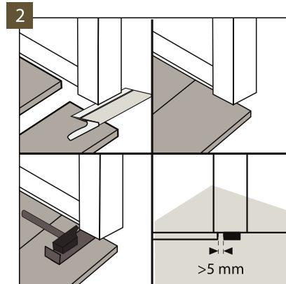
Las juntas de dilatación a lo largo de las paredes deben cubrirse con una tira decorativa, ensamblándola mediante pegamento o clips especiales. Se recomienda utilizar las tiras dedicadas a un determinado panel, lo que garantiza una excelente combinación de colores y una capa resistente a los rayados.
