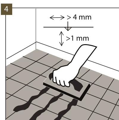
En el caso de la instalación sobre el soporte revestido de baldosas cerámicas, rellenar las juntas de las baldosas con el hueco más ancho de 4 mm y más profundo de 1 mm con un compuesto duradero para el relleno de puntos, por ejemplo, lechada de resina. Se permite la instalación sobre baldosas con rejuntados de no más de 5 mm de ancho y 1 mm de profundidad sin utilizar compuesto de nivelación, siempre que se utilice el Multiprotec Hardlay o Vinclic Solid como capa inferior.
