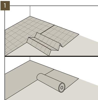
Coloque la base perpendicularmente a la dirección de colocación de los paneles. Las cintas vecinas de la subcapa deben quedar bien ajustadas y unidas por medio de un solapamiento o de la cinta AluTape, sin dejar ningún espacio redundante.
