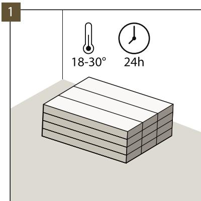
Se recomienda extremar las precauciones durante el transporte y almacenamiento de los paneles. Se recomienda transportar y almacenar el producto en posición tumbada. El embalaje no debe colocarse en posición vertical, ni almacenarse en locales húmedos o polvorientos, ni en lugares expuestos al impacto de temperaturas extremas.
