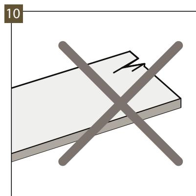
Antes y durante la instalación, controlar todos los paneles en las condiciones óptimas de iluminación. No utilizar paneles defectuosos.
