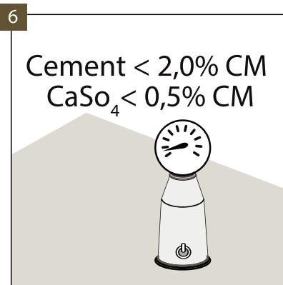
En el caso de la lechada de cemento, el contenido de humedad en el sustrato debe ser inferior al 2,0 %, y en el caso de la lechada de anhidrita, debe ser inferior al 0,5 %. En el caso de la instalación con el suelo radiante, los valores mencionados deben ser del 1,5 % y del 0,3 % respectivamente.
