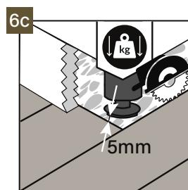
En el caso de cualquier objeto pesado colocado en el suelo (como los muebles de cocina, la isla de cocina, los armarios empotrados y otros muebles fijados permanentemente a la pared), deben dejarse juntas de dilatación de 5 mm a su alrededor. Recomendamos las siguientes formas de preservar los espacios de las juntas de dilatación:
