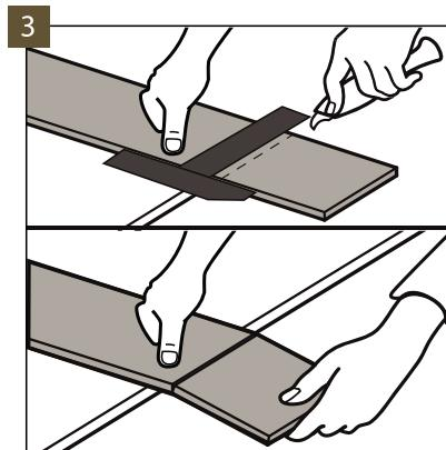
Para el corte adicional de los paneles del suelo, utilice un cuchillo afilado, corte la capa superior y luego rompa el panel de forma dinámica apoyándolo en el borde. Los paneles del suelo también pueden cortarse fácilmente con una sierra eléctrica.
