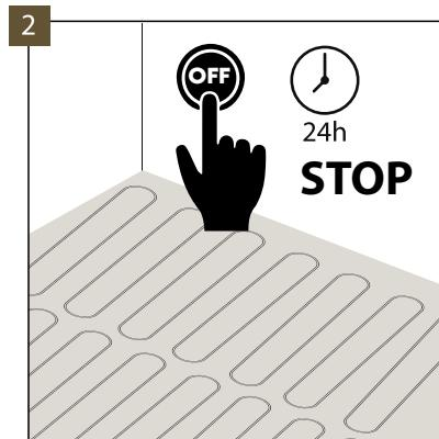
Antes de su instalación, los paneles deben someterse a la aclimatación de 24 horas a una temperatura de 18 a 30 °C, en el local donde serán instalados. En caso de transporte y/o almacenamiento a una temperatura inferior a +5 °C, el tiempo de aclimatación debe ampliarse a 48 horas.
