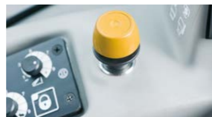
Conmutación electrohidráulica de la toma de fuerza
