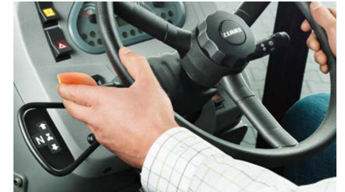
1 Palanca REVERSHIFT para maniobras de cambio rápidas y confortables, sobre todo en cabeceros o al apilar cajas.
