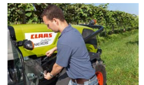
Rápidamente se puede plegar la protección antivuelco sin necesidad de herramientas.
