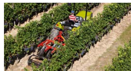
Con su larga distancia entre ejes, el NEXOS 240 demuestra una capacidad de tiro especialmente alta en los trabajos de suelo.
