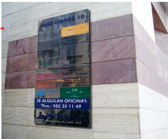
Fig 11. Directorio de lamas intercambiables de acero inoxidable de 1,5 mm de espesor. Las lamas van fijadas a la estructura mediante tornillos vistos. Todos los materiales utilizados son de acero inoxidable AISI 304. La rotulación se confecciona en vinilo de corte de primera calidad, granallado o impreso directamente mediante tintas UVI.
