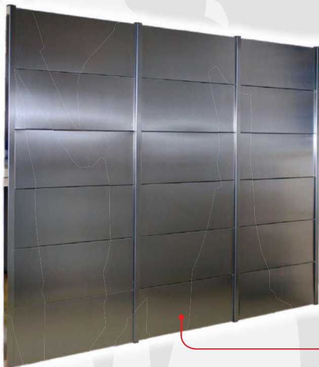
Fig 12. Un paso más en cuanto a la calidad de estos elementos: Este directorio totalmente fabricado en acero inoxidable consta de lamas de 1mm de espesor, plegado a modo de bandejas que se rotulan mediante impresión directa con tintas U.V.I. y permiten reproducir logotipos e imágenes a color. Toda la tornillería está oculta, y se puede construir en acero inoxidable pulido, satinado o combinación de las dos terminaciones.
